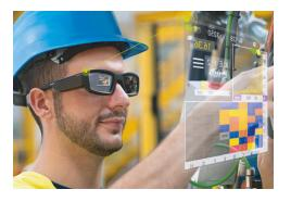
Программное обеспечение ScanView, поставляемое вместе толщиномером, имеет C В TOM числе работы возможность CO смарт-очками (очками реальности), работающими на базе дополненной Android. Это позволяет видеть показания прибора при измерениях в труднодоступных местах, ускоряет и упрощает работу оператора, особенно при построении С-сканов измеряемых объектов.
