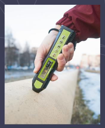
Толщиномер EM5000 не требует предварительной подготовки поверхности. Работает без контактной жидкости, через слой непроводящего покрытия толщиной до 4 мм. Измеряет толщину металла через грязь, лак, ржавчину, солевые отложения, краску, эмаль, пластик.
