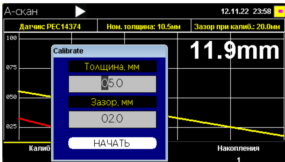
Калибровка в режиме А-скана
