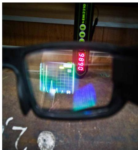
Мини ЭМА толщиномер EM2210 по Вашему желанию может быть дополнен **носимыми смарт-очками**. Носимые смарт-очки позволяют производить измерения ЭМА толщиномером EM 2210 в труднодоступных местах, где считывание показаний прибора с дисплея не представляется возможным или затруднено. Показания в этом случае отображаются на стекле смарт-очков и их всегда видно оператору.
